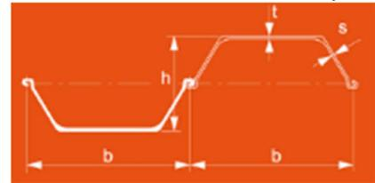
Figure 5 Exemple de profil en U. Source: ArcelorMittal
