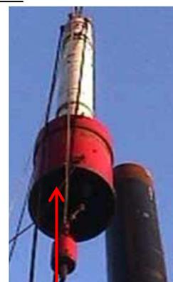
Figure 25 Exemple de casque de battage pour marteau hydraulique IHC Source : IHC.fr
