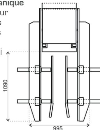
Guide standard avec fourreau battage max 450 mm
