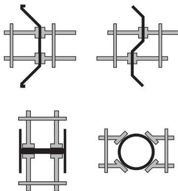
**Guide mécanique réglable** pour palplanches ou H à partir de 240 mm intérieur des ailes
