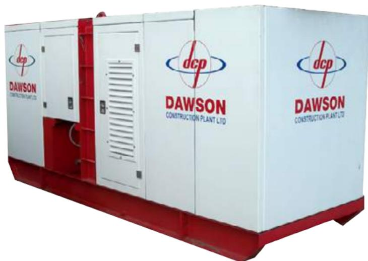
Ce groupe hydraulique Dawson est entièrement autonome, il comprend tous les réservoirs d'huile et de carburant, un moteur et le circuit hydraulique. Le groupe hydraulique est conçu pour être directement raccordé au marteau ; cependant, il peut être raccordé par le biais d'autres vannes hydrauliques pour effectuer d'autres opérations, en suivant les conseils du fabricant.
