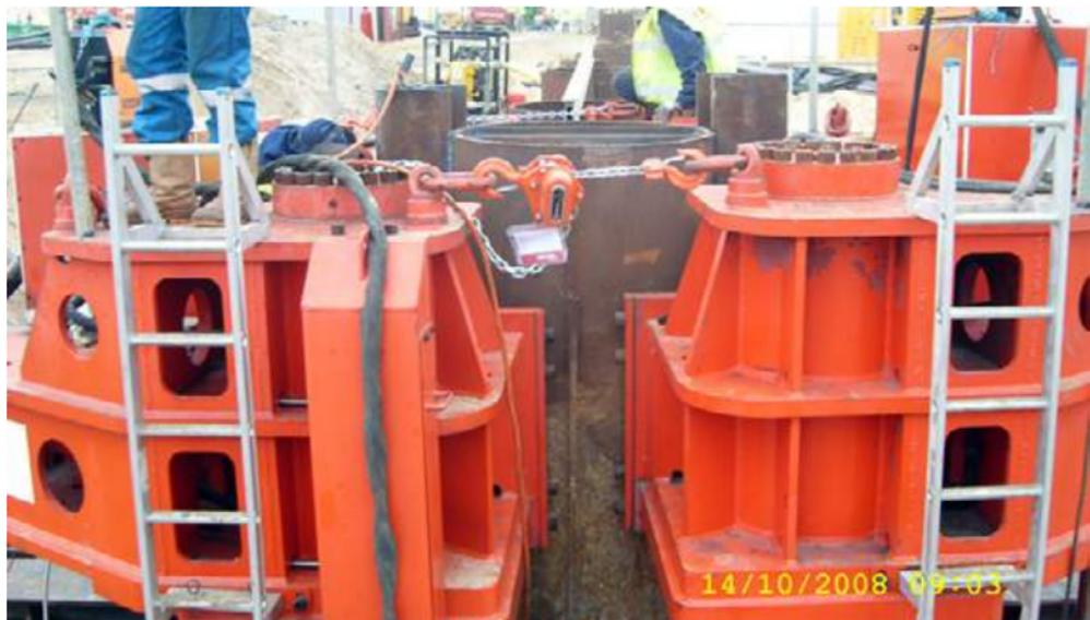
L'extracteur de profilés universel D.C.P. est un dispositif d'extraction de pieu hydraulique sans vibration qui permet l'extraction d'une large gamme de types de pieux sur une grande variété de types de sols.
