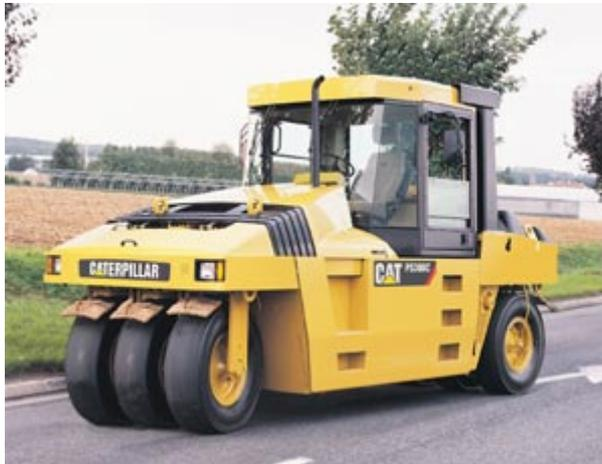
Figure 5. Compacteur à pneumatiques
