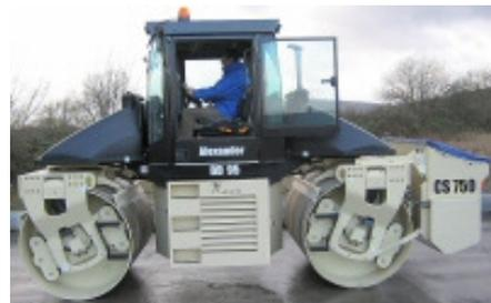
Figure 2. Compacteur vibrant  $L > 1.3$  m
