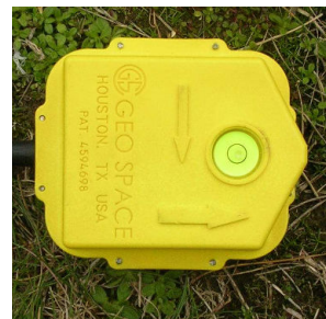
Figure 17 : Sens de mesure d'un géophone
