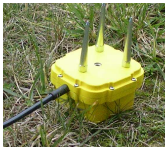
Figure 16 : Vue type d'un Géophone
