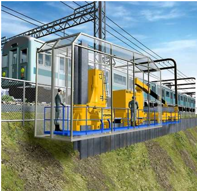
Figure 02 : Exemple d'opération de vérinage
