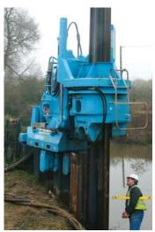
GIKEN propose une gamme de solutions innovantes pour le vérinage des palplanches et des tubes. Dans des terrains compacts, il est possible d'utiliser des options telles que le pré-forage et le water jetting afin de faciliter la mise en place des profilés.
