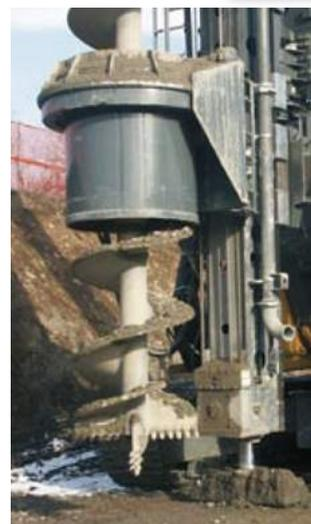
*Le nettoyeur de tarières consiste en un moteur hydraulique avec réducteur qui entraîne un grand palier circulaire équipé d'une coquille de décrochage démontable et changeable selon le diamètre de la tarière. La lame hélicoïdale sans fin de celle-ci passe dans la coquille, laquelle, équipée d'une molette profilée, enlève les déchets colmatés de la tarière.*
