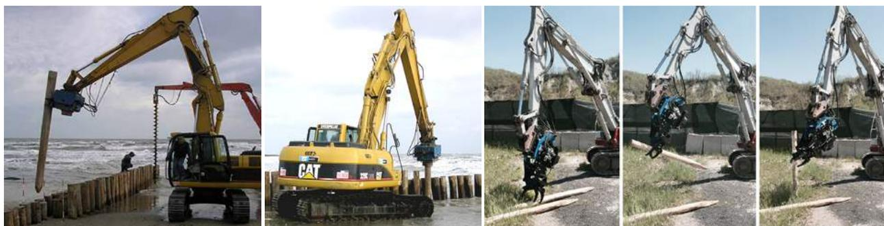
*Les enfonce-pieux Hydra permettent le fonçage de pieux bois ou béton par un seul opérateur, installé à l'intérieur de la cabine de la pelle.*
